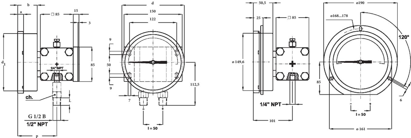
Radial (Montaje cod. **A**), con borde posterior para montaje a pared (Opcion cod. **C**): DN100-150
